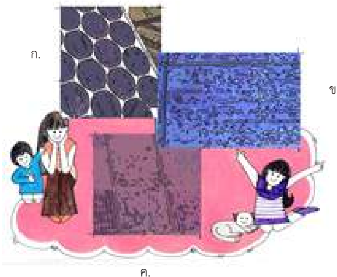
รูปที่ 1 เซลล์แสงอาทิตย์ที่ทำมาจากซิลิคอน ก.แบบผลึกเดี่ยว ข.แบบผลึกผสม ค.แบบอสัณฐาน
