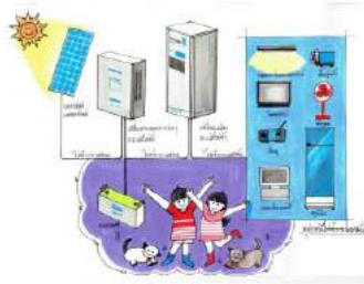
รูปที่ 5 ระบบผลิตไฟฟ้าจากแผงเซลล์แสงอาทิตย์ที่ใช้เครื่องแปลงกระแสไฟฟ้าชนิดใช้งานอิสระ
