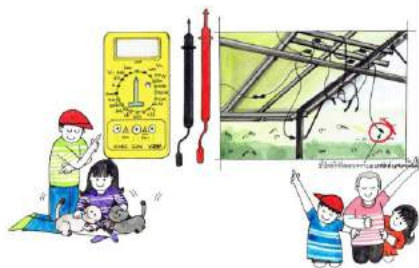
รูปที่ 19 การตรวจสอบแรงดันไฟฟ้าจากแผงเซลล์แสงอาทิตย์
